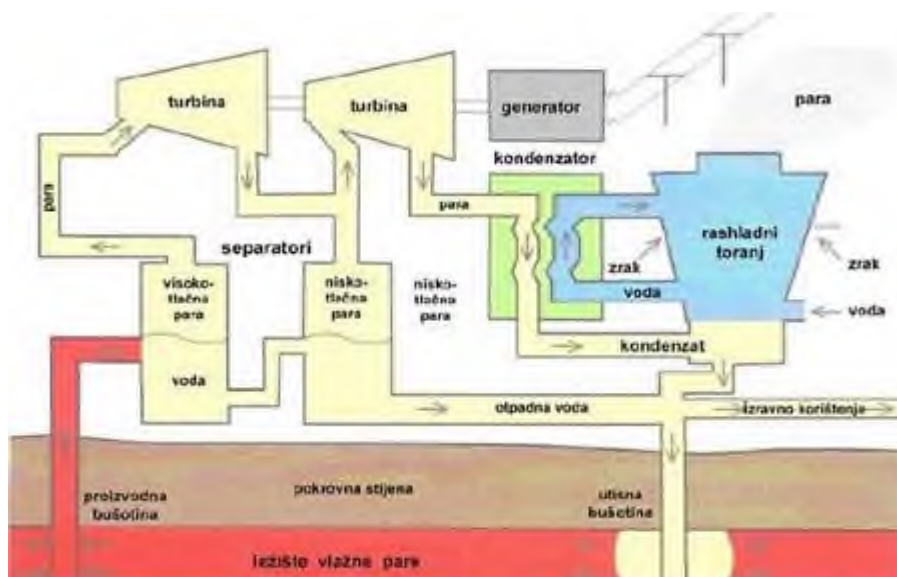
Slika 64.: Geotermalna elektrana s dvostrukim isparavanjem
