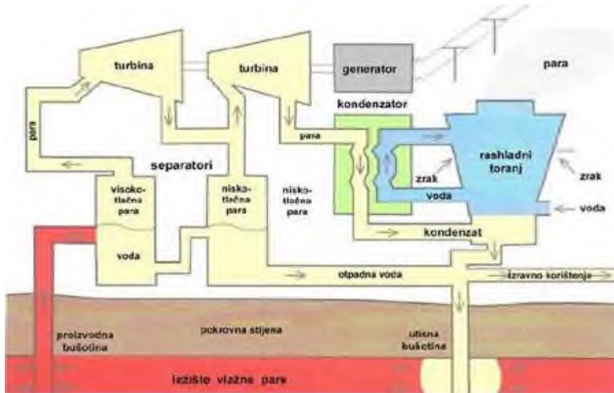
Slika 64.: Geotermalna elektrana s dvostrukim isparavanjem
