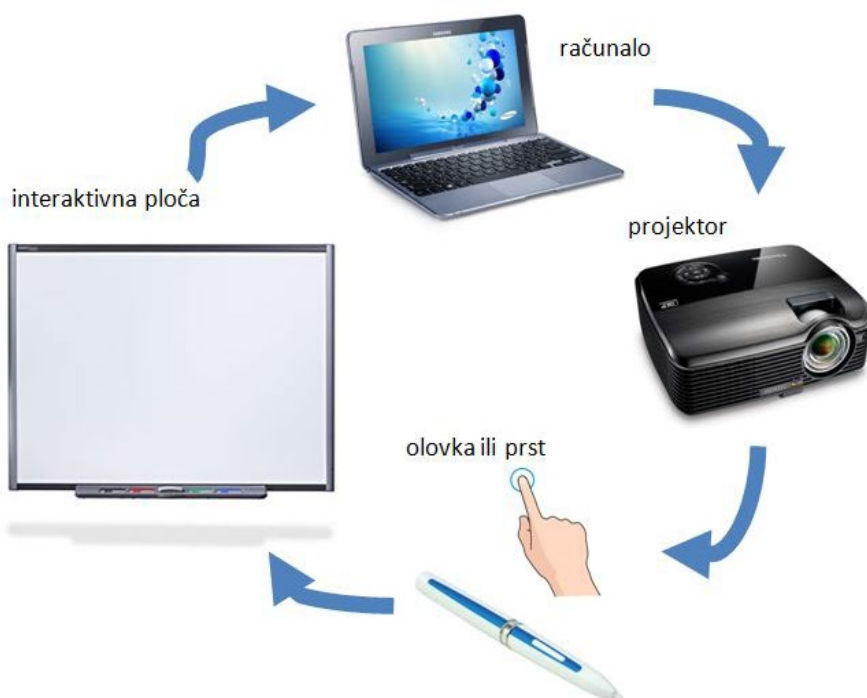
Shema 4: Povezanost računala i interaktivne ploče
