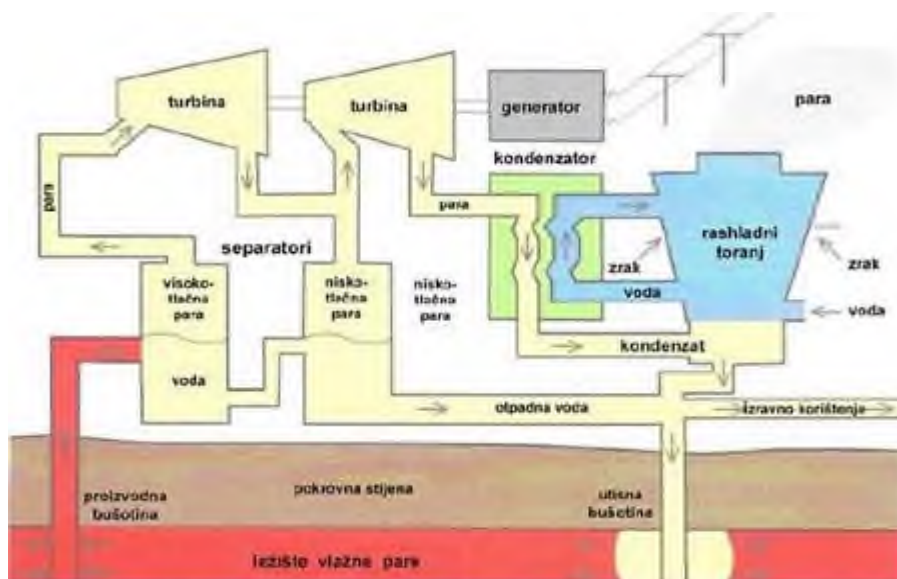
Slika 64.: Geotermalna elektrana s dvostrukim isparavanjem
